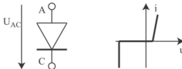
Figure 1-9 : Représentation symbolique et caractéristique électrique d'une diode réelle
