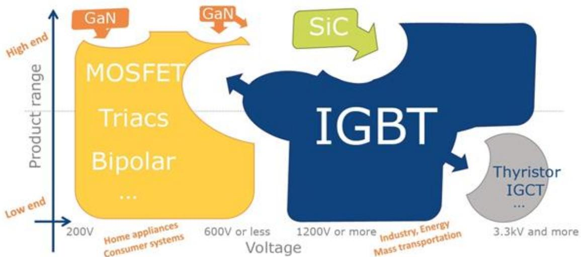
Figure 1-35 : Positionnement des différentes technologies avec l'arrivée des composants à grand gap [2]
