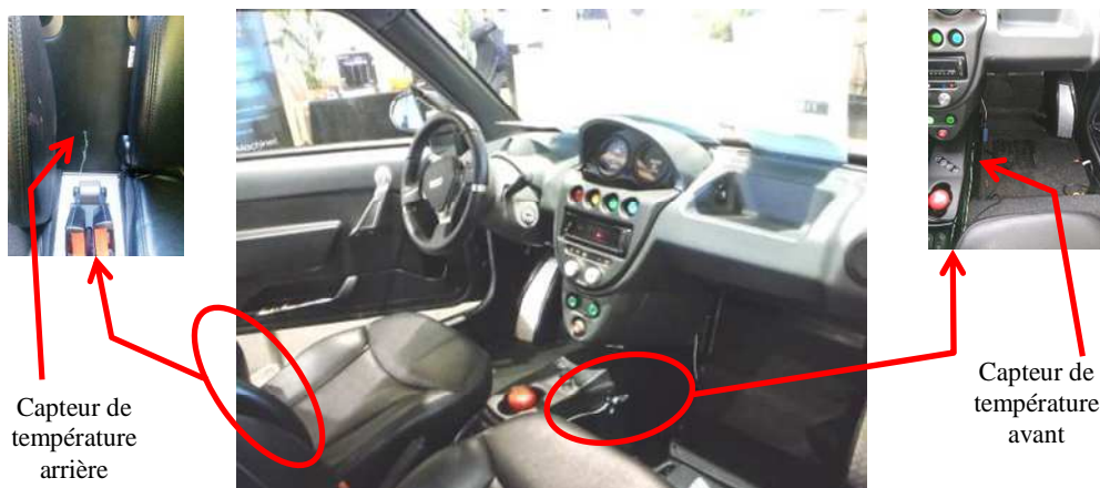
Figure E.3 : Position des deux capteurs de température habitacle
