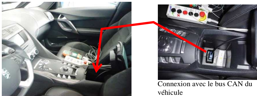
Figure 3.21 : Véhicule DS5 HY4 sur banc à rouleaux 4 roues motrices pour la validation de la thermique moteur
