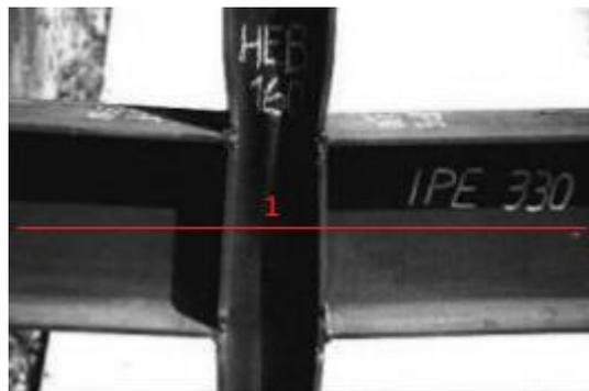
Figure II-3 - Assemblage de poteaux métalliques soumis à une compression selon l'axe 1 [2].
