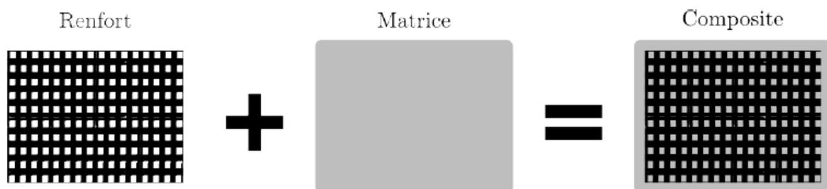
Figure I-6 - Matériau composite à renfort fibreux [15].
