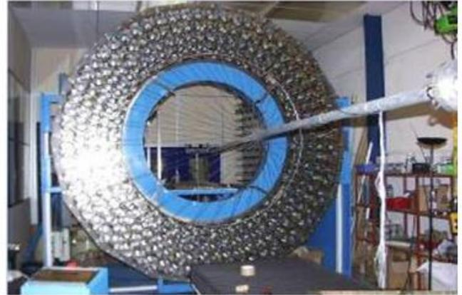
Figure I-27 - Représentation d'une tresseuse interlock [113].
