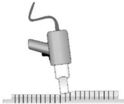
Figure I-25 - Représentation d'un stratifié renforcé par Z-pinning [15]
