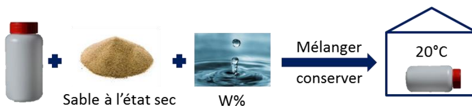
Figure 50 : Procédure de pré-saturation des sables
