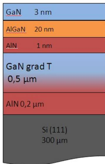
FIGURE 5.7: Schéma de la structure des couches tampons de type III avec gradient de température
