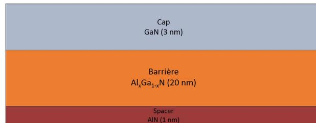
FIGURE 3.10: Schéma de la zone active d'un HEMT AlGaN/GaN
