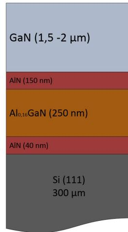
FIGURE 3.8: Structure des couches tampons élaborées par EJM et utilisées au CRHEA dans l'optique de réaliser un composant pour la RF ou la puissance
