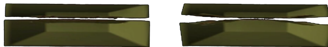
Figure 4.22 – Entre les deux solides sont répartis des ressorts de raideurs différentes : Au centre se trouve les ressorts les plus rigides. La première image montre le fluide dont on a initialement forcé la position au centre de la scène. En seconde image, on voit que le fluide préfère se déplacer vers l'endroit qui résiste le moins, c'est-à-dire sur les cotés où les ressorts sont plus élastiques.
