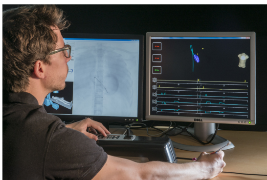
Figure 1.6 – Manipulation d'un cathéter utilisant le système VIST (conçu par Mentice Corp.) pour obtenir la position virtuelle du cathéter dans la simulation.
