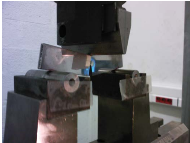
Figure 6.11: Dispositif d'essai quasi-statique de ténacité d'une éprouvette AISI304 soudée.
