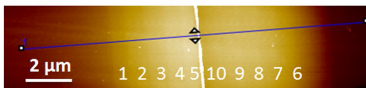
Figure 17 : image AFM de l'échantillon poli, avec indentification des couches.
