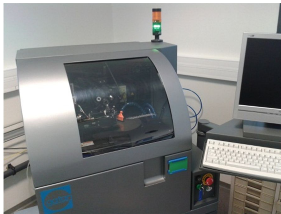
Figure 1 : polisseuse Gatan Centar Frontier
