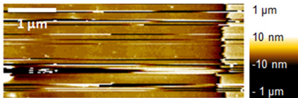
Figure 21 : image de topographie sur l'échantillon SiGe. La forte présence de défauts perturbe considérablement la mesure, comme en témoignent les stries latérales.
