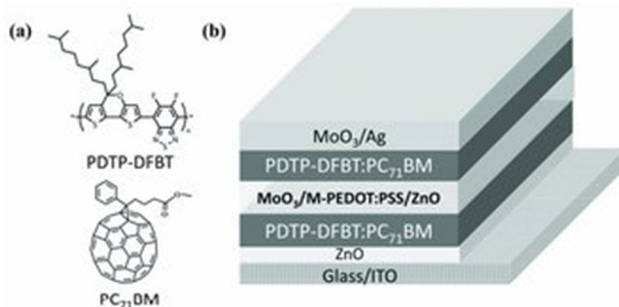
Figure 2 : (tirée de [11]) cellule solaire organique développée par You et al., ayant atteint le rendement record de 10,2%. (a) formules chimiques des matériaux donneur (PDTP-DFBT) et accepteur (PCBM) employés (b) structure de la cellule.
