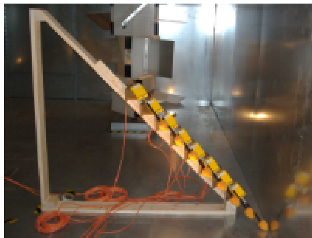
FIGURE 2.2 – Capteurs de champ placé près des parois[29]
