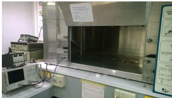
FIGURE 4.10 – Banc de mesure en cellule TEM
