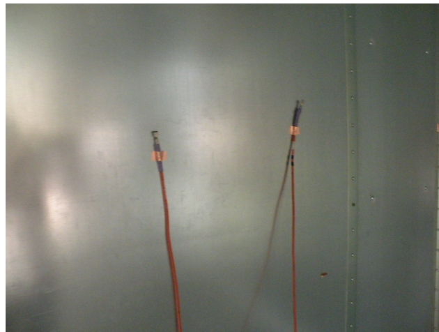
FIGURE 3.8 – Capteurs de courant de surface positionnés sur une paroi de la CRBM
