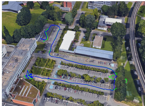
FIGURE 5.8 – Trajectoire du véhicule dans le cas de l'utilisation des données GPS seules (en vert) et dans le cas du couplage serré GPS/odomètre (en bleu).
