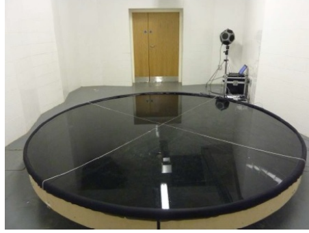
FIGURE 1.20 – Configuration de mesure avec table tournante permettant la mesure des coefficients d'absorption et diffusion, d'après [68]
