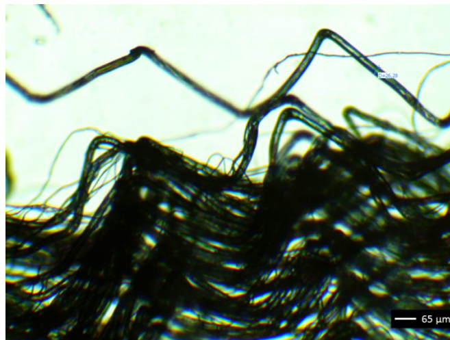
Figure D4 : Cliché obtenu au microscope optique des fibres PP_{\text{iles}}PA6_{\text{mer}} après les étapes de frisage et de coupe
