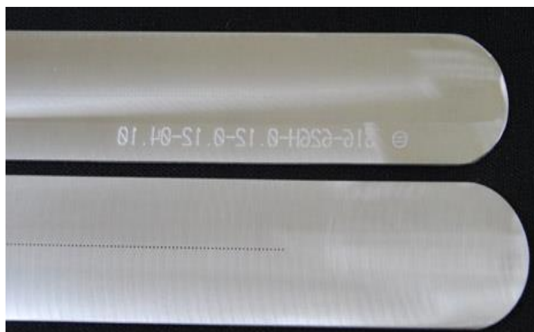
Figure D16 : Exemples de lames utilisées dans le procédé d'hydroliage du CETI
