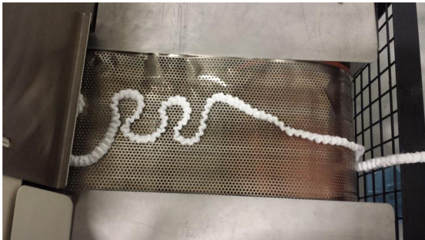
Figure D2 : Formation du câble de filaments bicomposants pour le procédé de cardage
