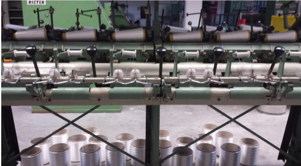
Figure D1 : Assemblage des bobines de filaments issus du filage bicomposant
