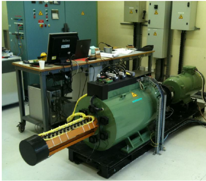
FIGURE 2.2 – Banc d'essai comprenant la maquette de turboalternateur.
