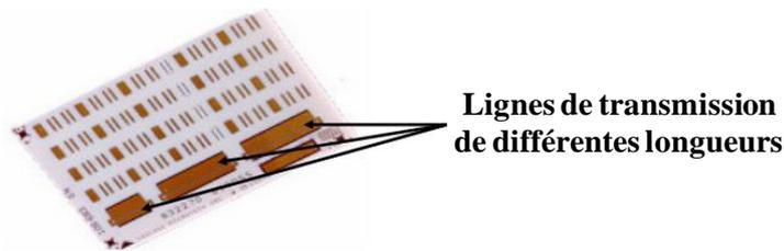
*Figure 11: Dispositifs de validation de calibrage dans l'ISS*
