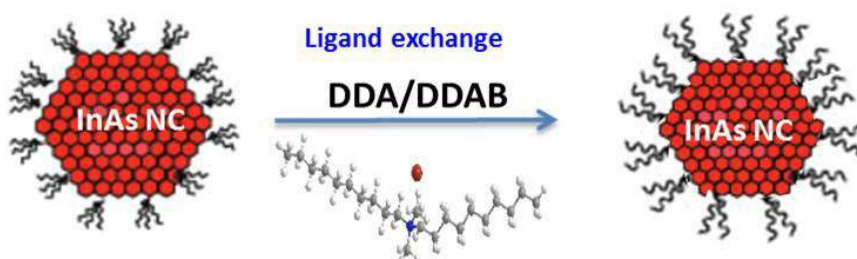
Figure 3.6 : Schéma montrant le processus d'échange de ligand TOP à DDA/DDAB sur NC colloïdal sphérique d'InAs.
