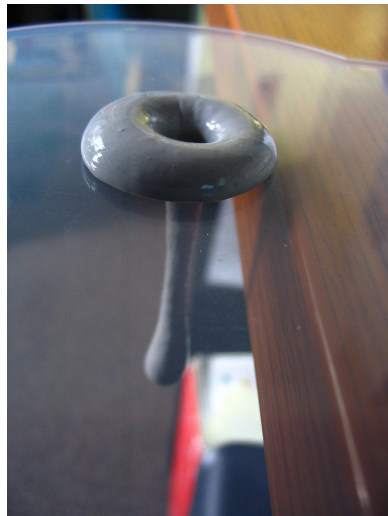
FIGURE I.1 – Silly Putty s'écoulant à travers un trou : réponse sous contrainte constante due aux forces de gravité à un temps relativement long (image extraite du site Wikipédia © Erik Skiff, création : 29 juin 2006).
