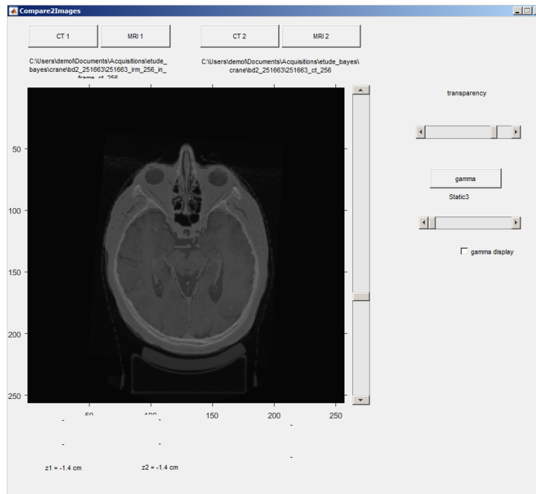
Figure 4-1 : GUI développé sous Matlab pour permettre la visualisation de deux images, ainsi que la visualisation d'un outil de comparaison d'image. Ici, la qualité du recalage rigide d'un CT et d'une IRM est visualisée par transparence des images.
