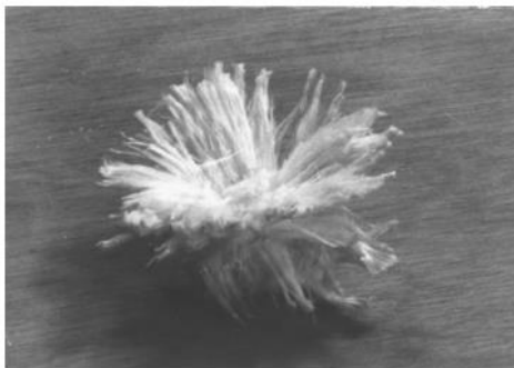
Figure 55 : Structure sacrificielle en tresse [167]
