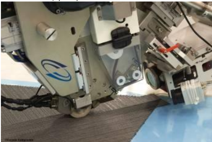
Figure 11 : Tête de placement (Coriolis : http://www.coriolis-composites.com/ )
