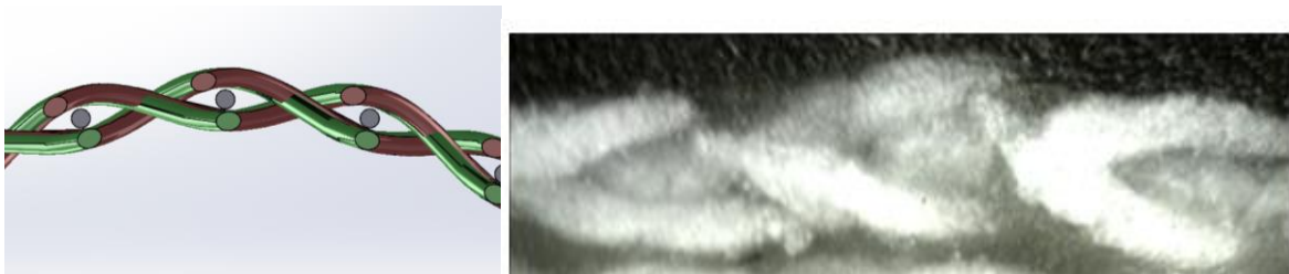
Figure 41 : Vue en coupe d'une tresse modélisée et d'une tresse réelle
