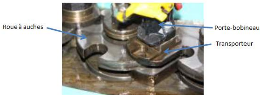
Figure 10 : Illustration de roue à aubes et transporteur
