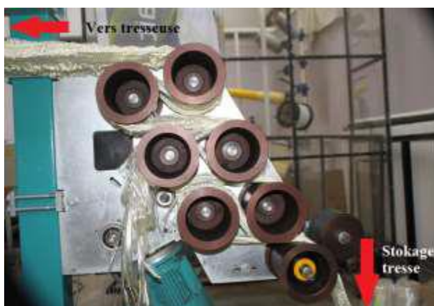
Figure 14 : Système de tirage et rouleau presseur
