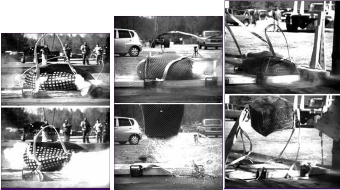
Figure 6 : Résultats après Impact. a) sans exosquelette, b) avec exosquelette, c) avec exosquelette et jonctions entre les faces optimisées [9]
