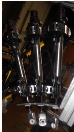
Figure 163 : Vérins d'alimentation en fils de trame de la « TTF »
