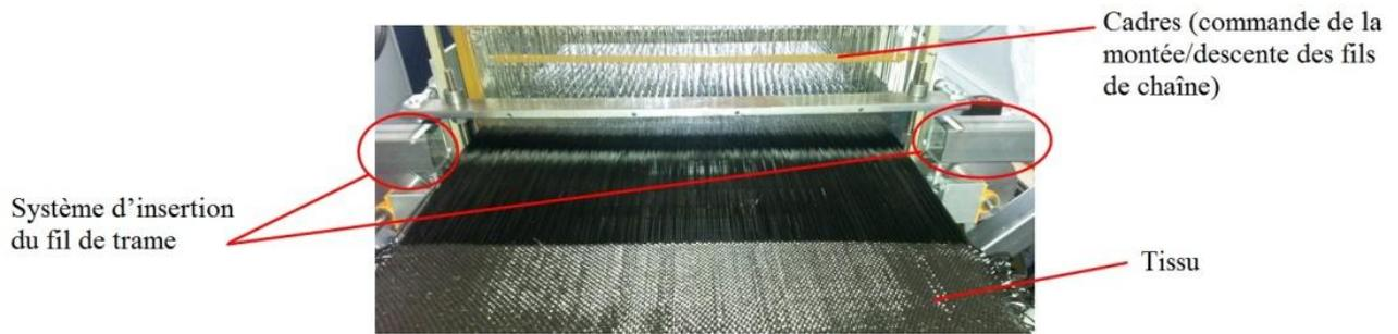
Figure 14 : Vue en face avant des différents éléments d'une machine à tisser
