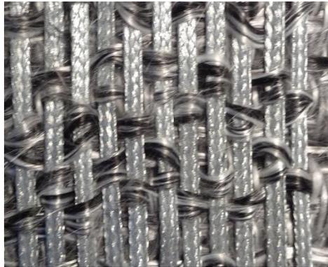
Figure 82 : Intégration de tresses métalliques en sens chaîne
