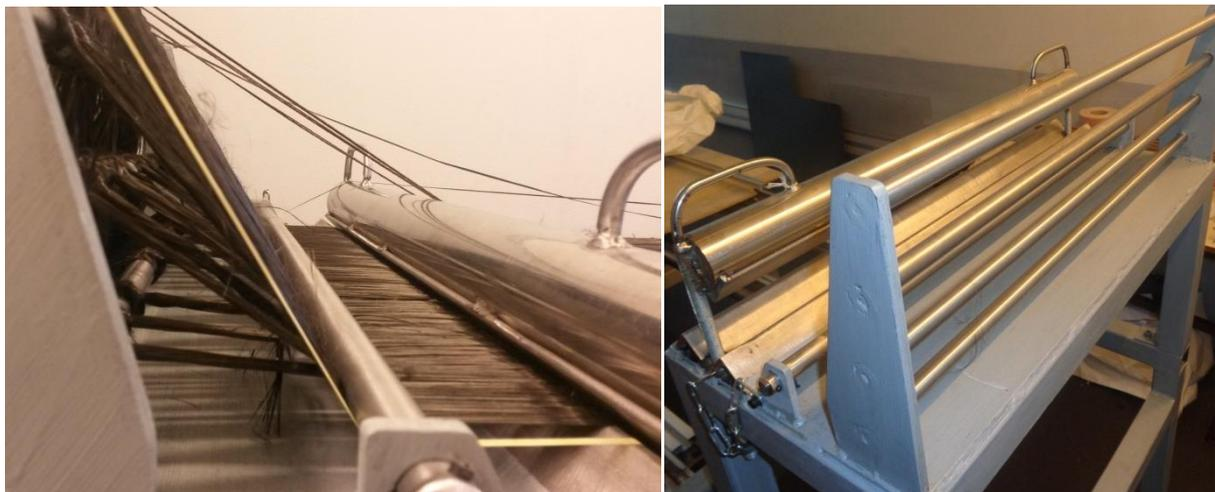
Figure 142 : Système de mise en tension et de blocage des fils de chaîne de la machine à tisser CARBOMAT
