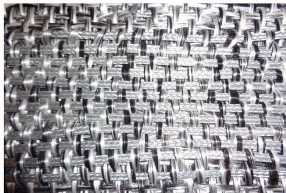
Figure 81 : Intégration de tresses métalliques en sens trame
