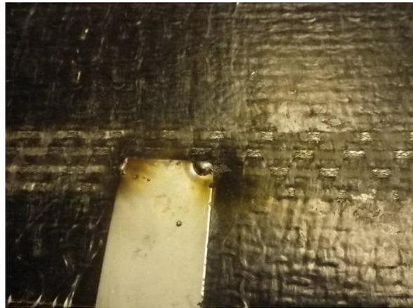
Figure 89 : Apparence de l'assemblage composite/métal soudé
