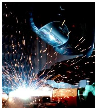
Figure 76 : Soudage semi-automatique [110]
