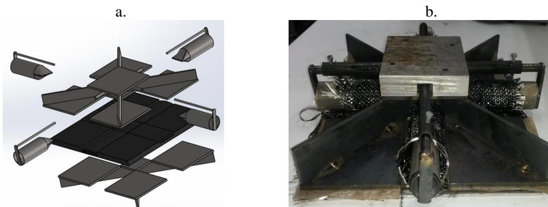
Figure 102 : Premier système de consolidation Railmapicc : a. modélisation et b. système réalisé
