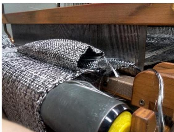
Figure 117 : Résultat de la technique de tissage créneau
