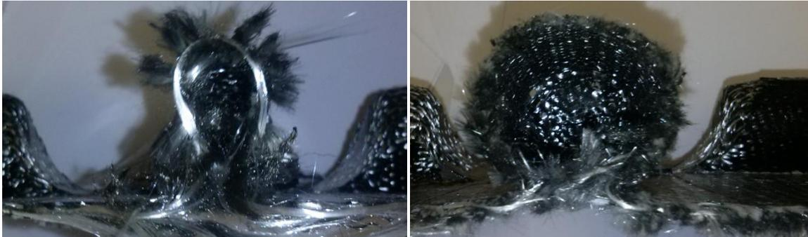
Figure 113 : Préforme sans adaptation à gauche, et préforme finale à droite
