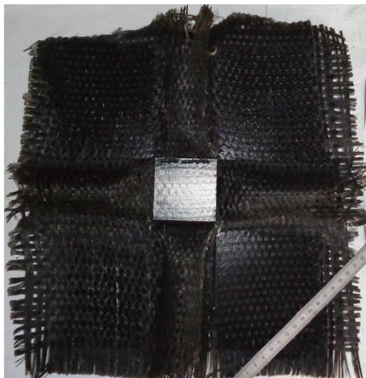
Figure 119 : Préforme consolidée avec le premier système de consolidation
