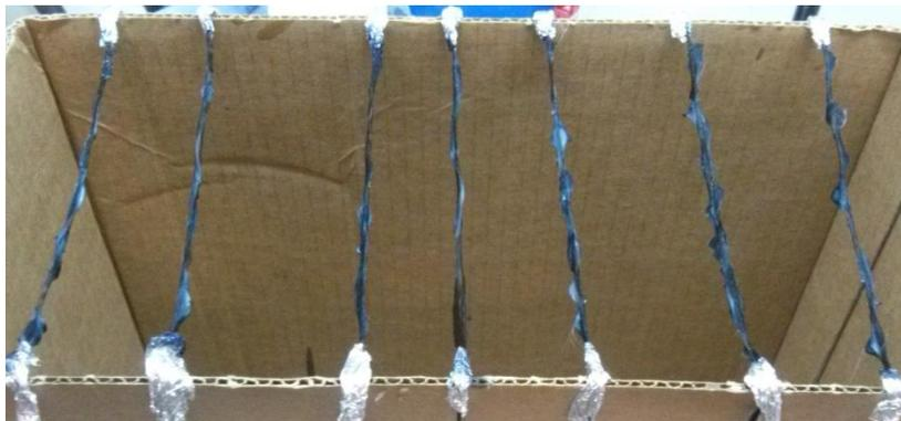
Figure 40 : Fils comm l s enduits avec la solution de latex : PEDOT-PSS
