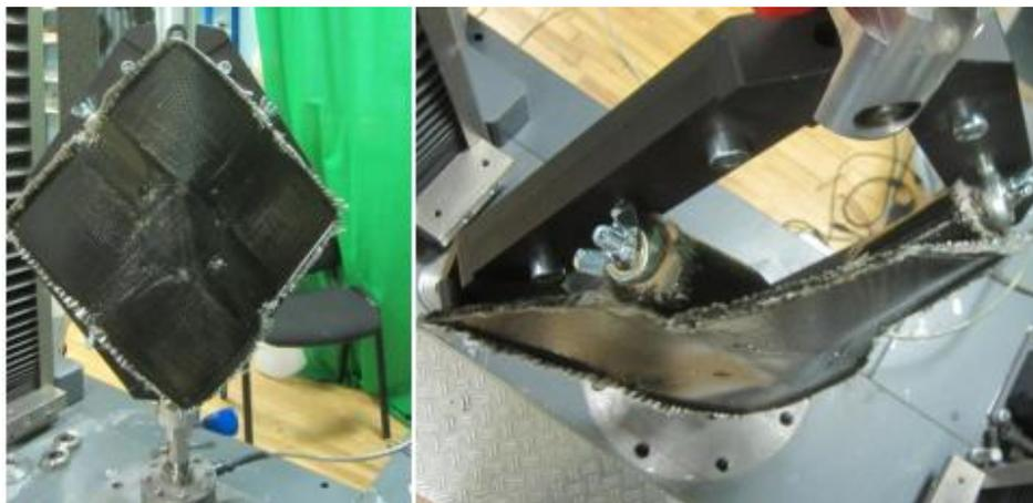
Figure 109 : Essai de cisaillement dans le plan
