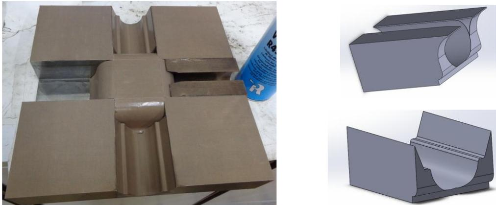
Figure 120 : Second système de consolidation avec inserts interchangeables en fonction de la version de préforme à consolider
