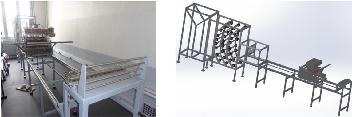
Figure 125 : Machine à tisser utilisée pour le tissage des préformes de l'application Aéronautique
