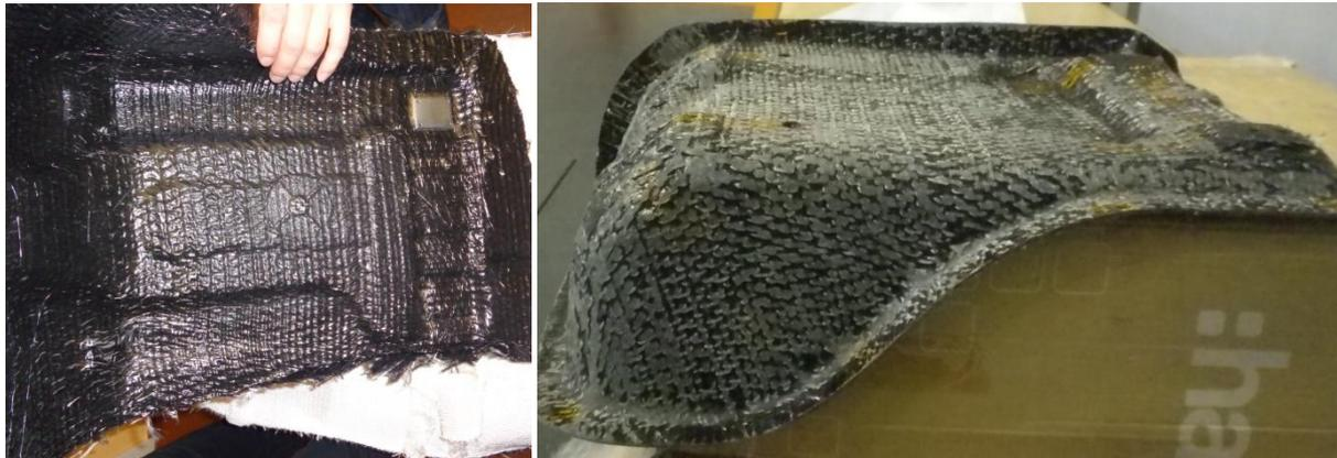
Figure 74 : Pièce consolidée sous bâche à vide à gauche et sous autoclave à droite
