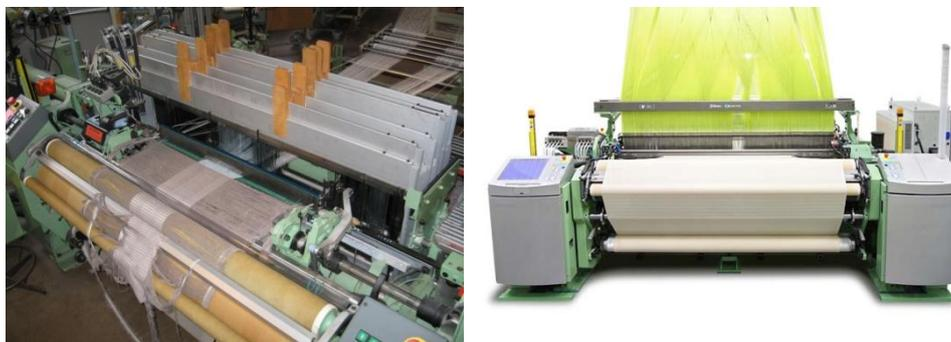
Figure 16 : Deux types de machine à tisser : (gauche) Armuré – (droite) Jacquard
