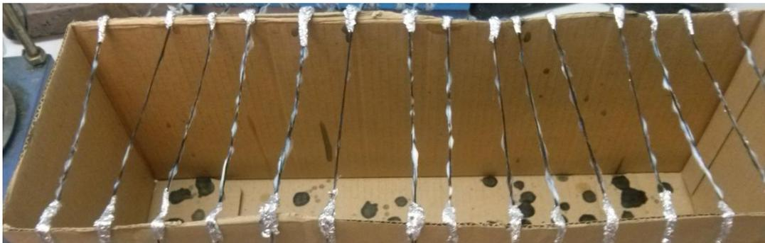
Figure 39 : Fils comm l s enduits de latex pour la r alisation de fils capteurs
