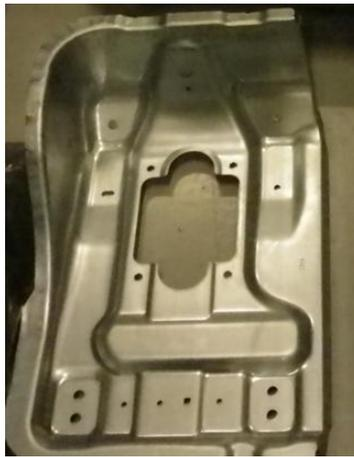
Figure 69 : Version métallique initiale de l'assise de siège TRUCK-MAPICC
