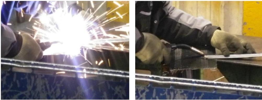
Figure 79 : Soudage semi-automatique
