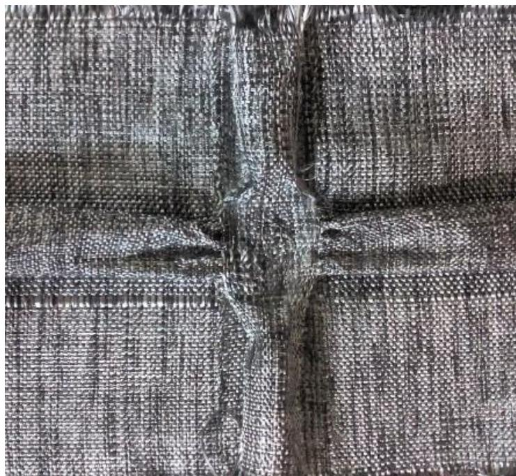
Figure 114 : Aperçu global de la préforme tissée finale
