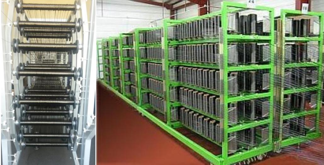
Figure 17 : Deux types d'alimentation en fils de chaîne : (gauche) par ensouples ou (droite) par bobines
