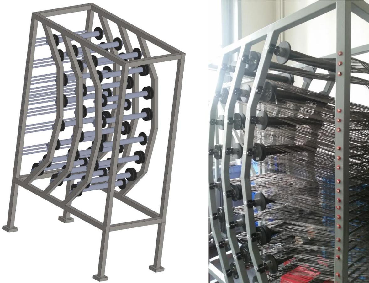
Figure 145 : Cantre d'ensouple de la machine à tisser CARBOMAT : à gauche, représentation en mode conception et à droite une photographie du cantre une fois la préparation de la machine au tissage réalisée
