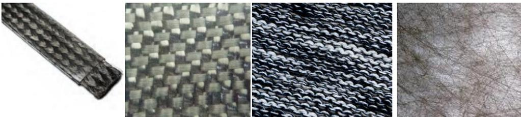
Figure 10 : Différents types de structures 2D : (de gauche à droite) une tresse, un tissu, un tricot et un non-tissé.
