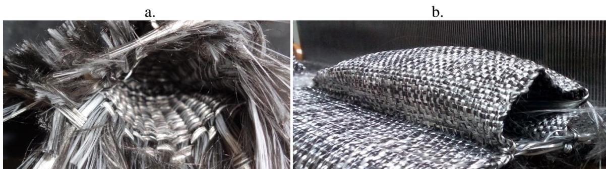
Figure 100 : Solution Railmapicc : a. un déliage et b. un créneau
