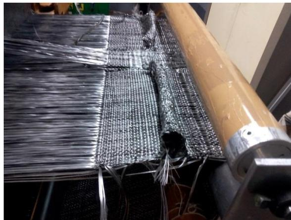
Figure 112 : Tissage de la deuxième partie de la préforme composée de deux zones en tissage créneau et d'une zone centrale interlock
