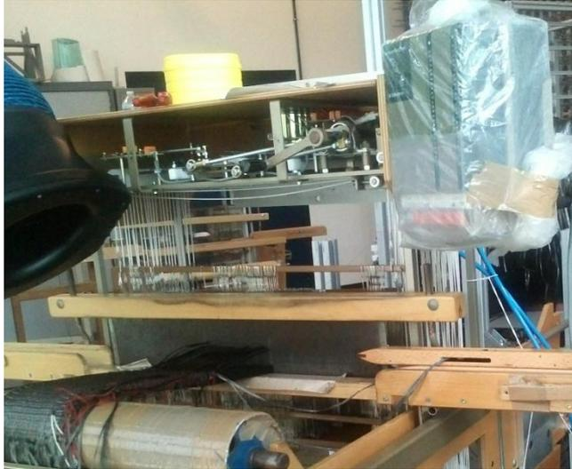
Figure 136 : Conservation du système électro-magnétique de sélection des cadres et du boîtier de lecture électronique de programme de dessin.
