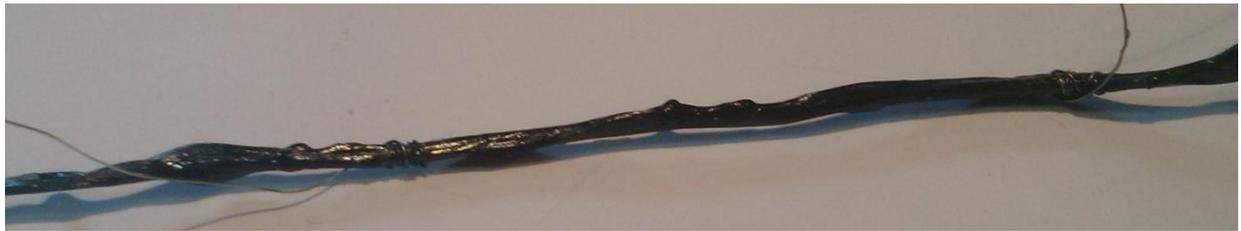
Figure 42 : Aperçu du fil capteur réalisé à base de fil commélé verre-polypropylène
