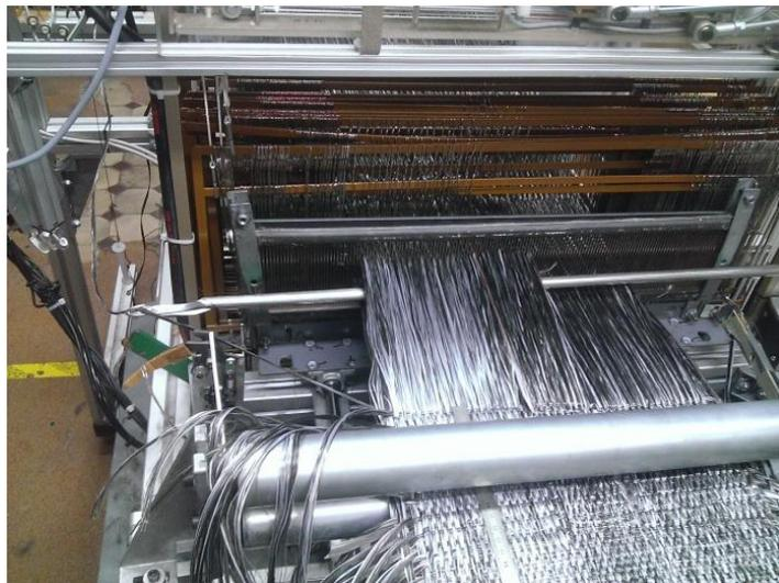
Figure 22 : Technique de tissage par parties
