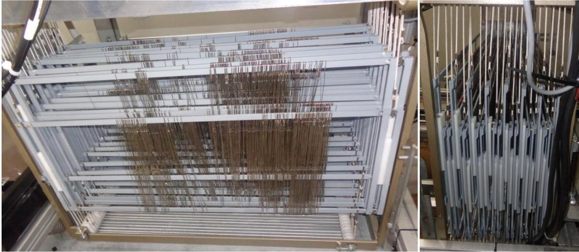
Figure 162 : Nouveaux cadres avec le système de séparation des cadres de la machine à tisser TTF
