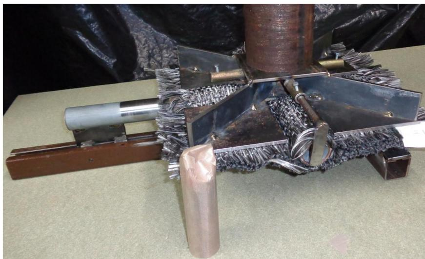
Figure 104 : Insertion d'un tube métallique dans le premier système de consolidation
