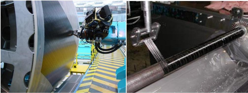
Figure 9 : Système de placement de fibres (gauche) - et d'enroulement filamentaire (droite).
