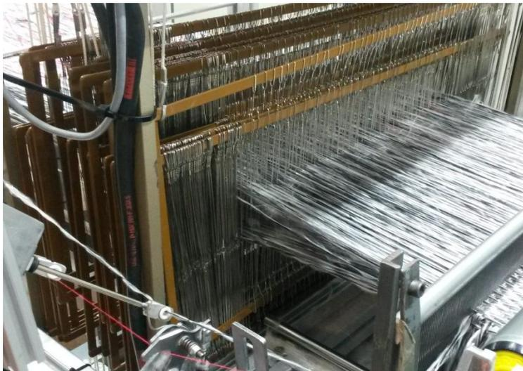
Figure 161 : Problème de positionnement vertical des cadres lors du tissage
