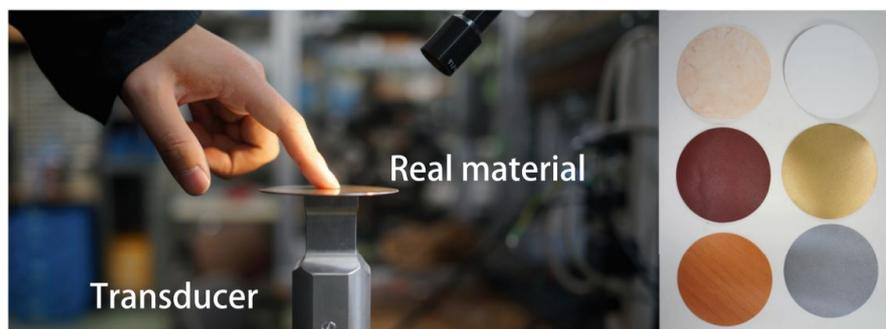
FIGURE 1.33: (à gauche) Dispositif expérimental, (à droite) Des échantillons de papiers de texture variable [77]
