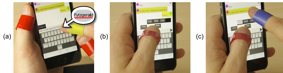
FIGURE 3.9: Sélecteur et déclencheurs sur smartphone* : (a) le majeur corrige un mot ; (b) le sélecteur pouce affiche Lilantotix ; (c) l'index déclenche une copie .
