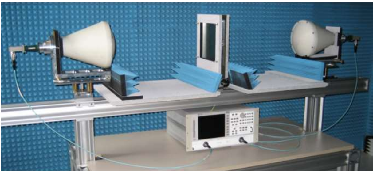
Figure II. 1 Illustration d'un banc de mesure pour la caractérisation en espace libre [II.1].
