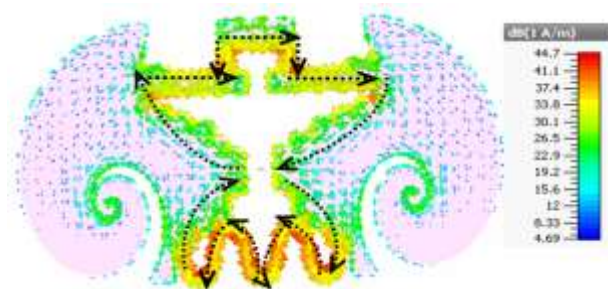
Fig. III.75 Lignes de champ électrique (sans liquide).
