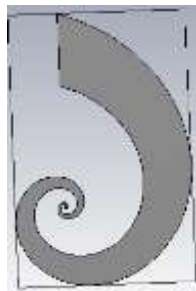
Fig. III.72 Tronçon d'une antenne spirale logarithmique.
