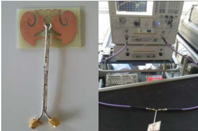
Fig. III.11 banc de mesure d'impédance d'antenne RFID UHF.
