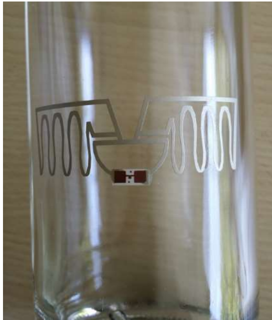
Fig. III.39 Photographie du tag intégré sur la bouteille.
