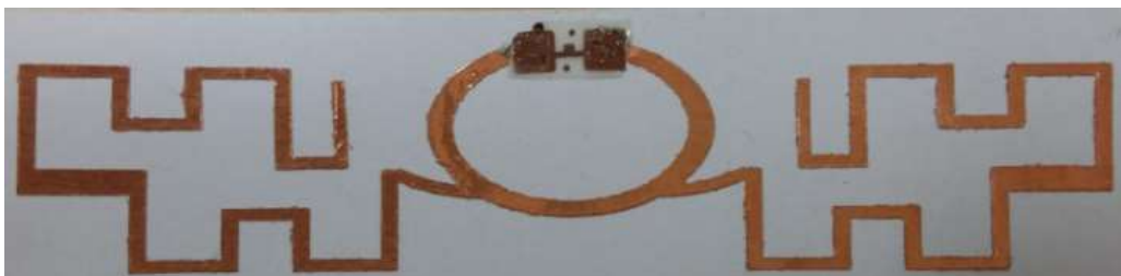
Fig. III.22 Photographie du tag final réalisé sur papier.
