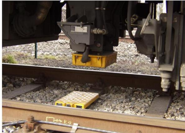
Figure 1.8 Eurobalise fixée entre les rails et interrogateur fixé sous le train ([www.siemens.com](http://www.siemens.com)).
