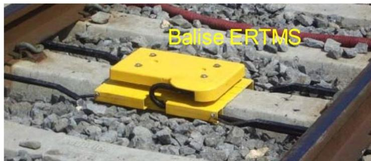
Figure 1.2 Balise ETCS/ERTMS fixée entre les rails d'une voie ferrée ([www.mermecgroup.com](http://www.mermecgroup.com))
