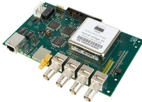
Figure 3- 12 : Photo de la carte référence d'horloge CTL430
