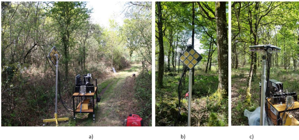
Figure 4-9 : Différentes positions et orientations du réseau TX: a) Réseau perpendiculaire au sol Tx2 en zone 2, b) Réseau Tx1 perpendiculaire au sol en zone 1 et c) réseau Tx1 parallèle au sol en zone 1
