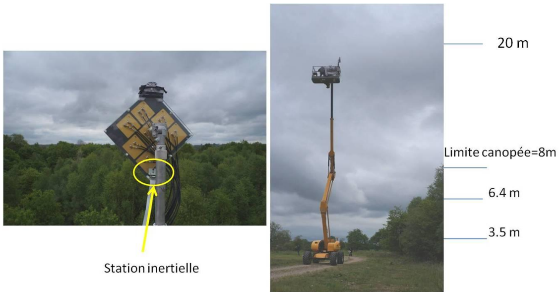
Figure 4-10 : Réseau d'antennes Rx: a) vu du réseau à une hauteur de 16m et b) Nacelle élévatrice dépliée pour atteindre une hauteur maximale du réseau de 20 m
