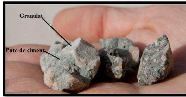
Figure 30 : Gravier de Béton Recyclé (GBR).
