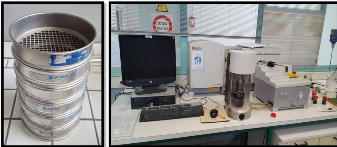
Figure 17: Tamis (A Gauche) Granulomètre laser de type Coulter LS 230 (A droite).
