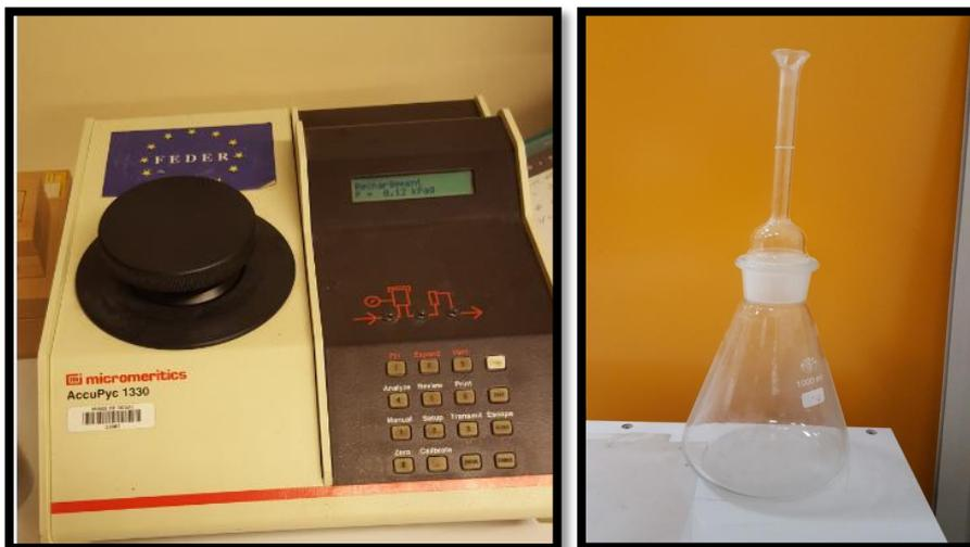
Figure 19 : Pycnomètre à hélium (à gauche) et Pycnomètre à eau (à droite).
