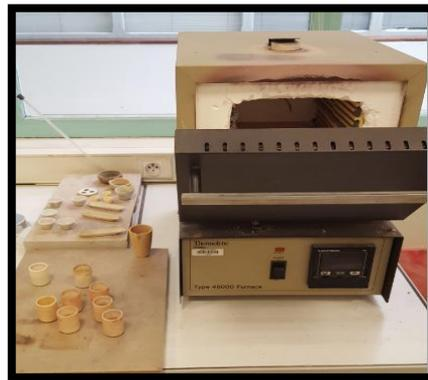
Figure 20 : Four pour la mesure de la perte au feu (P.A.F).
