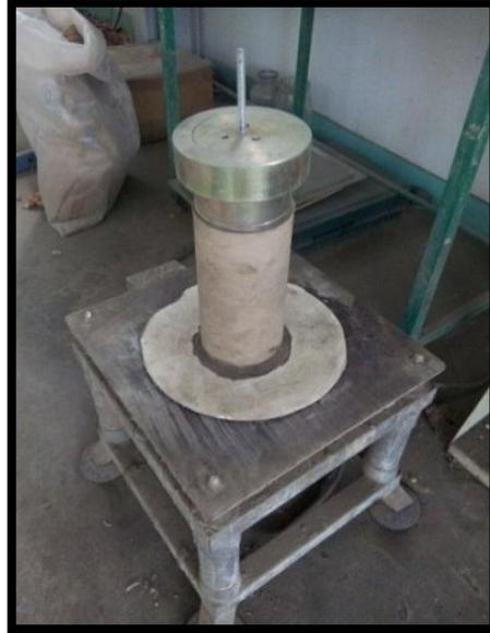
*Figure 40 : Méthode par vibration+10kPa.*
