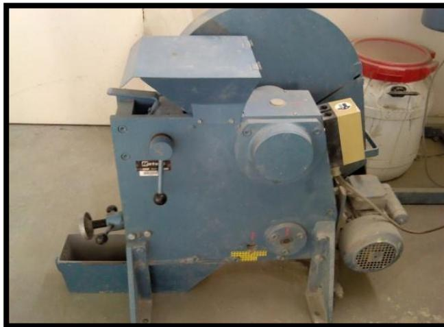
*Figure 35 : Concasseur de laboratoire à mâchoire.*
