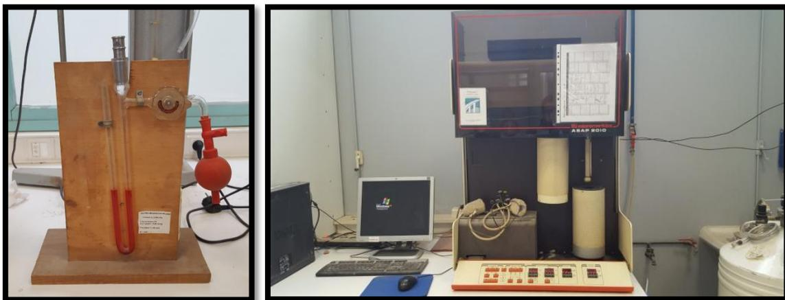
Figure 21 : Perméabilimètre de Blaine (A gauche) et l'Appareil pour mesurer la surface spécifique BET (A droite).
