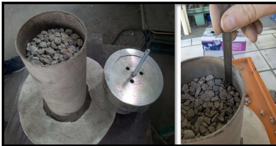
*Figure 41: Perte de volume après vibration sous pression de 10 kPa.*
