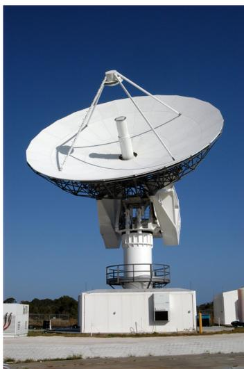
FIGURE 3 – Antenne de 15m de diamètre d'un radar en bande C (4 - 8 GHz) de la NASA, de 3 MW. Ce radar sert à l'observation des objets astronomiques.
