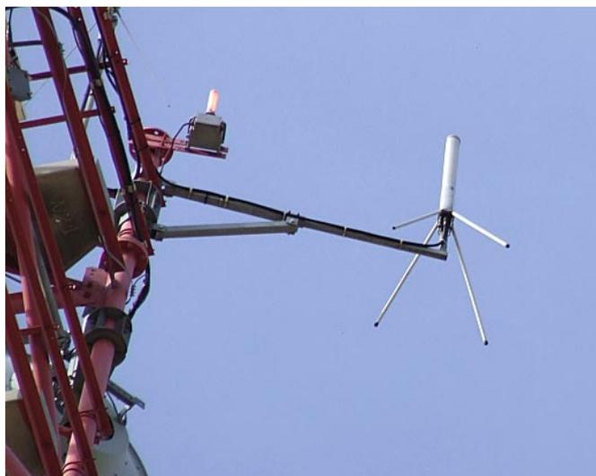
FIGURE 6 – Exemple d'antenne pour le réseau Rubis de la Gendarmerie nationale.
