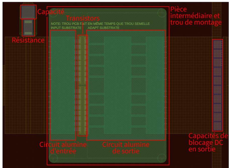
FIGURE 123 – Layout de l'amplificateur, agrandissement sur les transistors.
