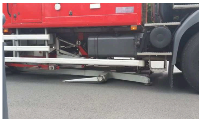
Figure 3.3 : Mesure de déflexion au Déflectographe FLASH
