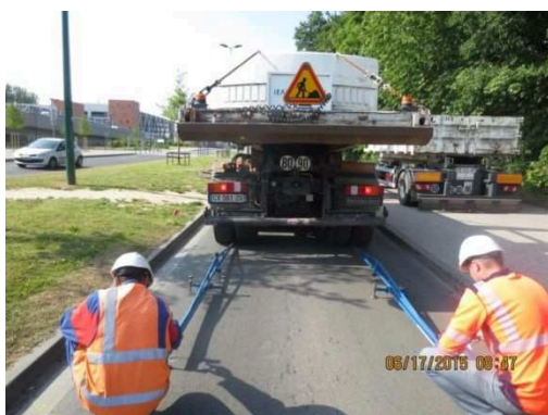
Figure 3.2 : Mesure de déflexion à la poutre Benkelman
