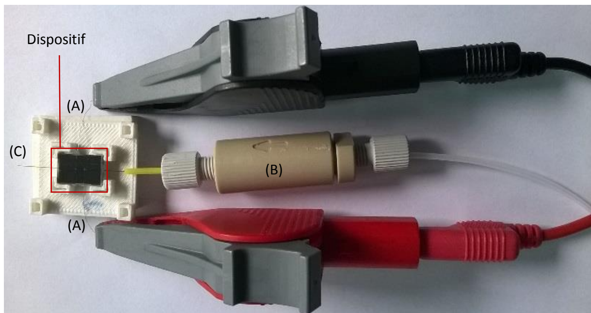
Figure 2-11 : Dispositif complet connecté. Les pinces crocodiles rouges et noires attachées aux électrodes (A) sont reliées au circuit électrique extérieur. Le flux de liquide est généré par le pousse seringue (non visible) dans le tuyau transparent entre dans le dispositif par le capillaire d'entrée à l'aide de la connectique microfluidique (B) et ressort par le capillaire de sortie (C).
