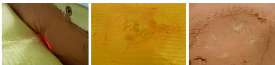
Figure III.72. Adhésion entre la plastiline et la face arrière du Kevlar ®
