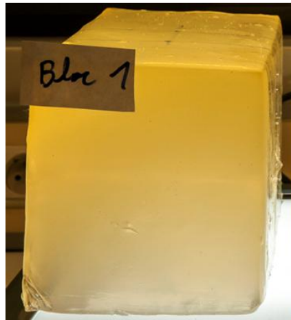
Figure II.27. Surface avant d'un bloc de gélatine après impact. Pas d'endommagement apparent
