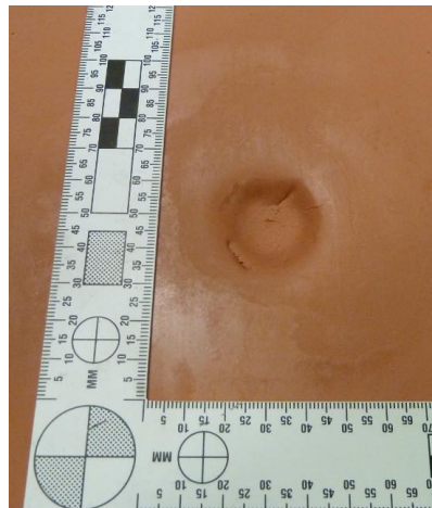
Figure III.59. Aspect typique de la surface de la plastiline après impact sur aluminium
