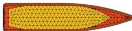
Figure I.38. Modèle numérique du projectile perforant utilisé dans l'étude de Krishnan et al. [21]
