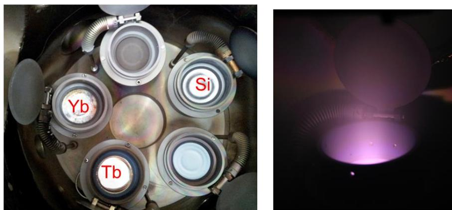
Figure IV-47. Dispositifs de pulvérisation cathodique magnétron à 5 cibles (Images CIMAP)
