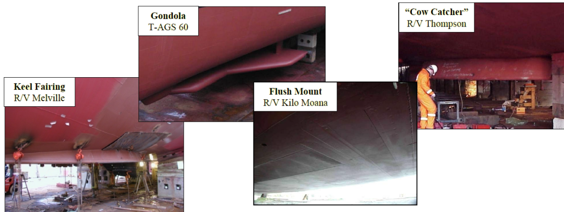
FIGURE 1.4 – Différents types d’implantation de sonars afin de réduire l’influence du phénomène de Bubble Sweep-down
