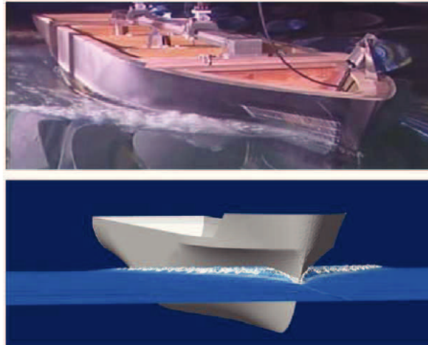
FIGURE 1.12 – Extrait de Marrone et al. (2012). Simulation de la vague d'étrave déferlante par SPH. Comparaison avec une photographie de l'écoulement.
