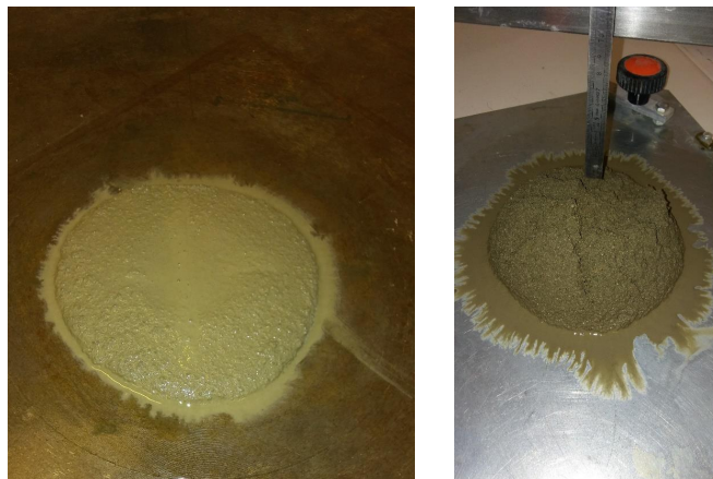
FIGURE 4.9 – Phénomènes de ségrégation observés dans la phase de saturation
