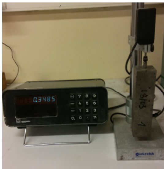
FIGURE 4.34 – Appareillage pour la mesure du retrait et gonflement
