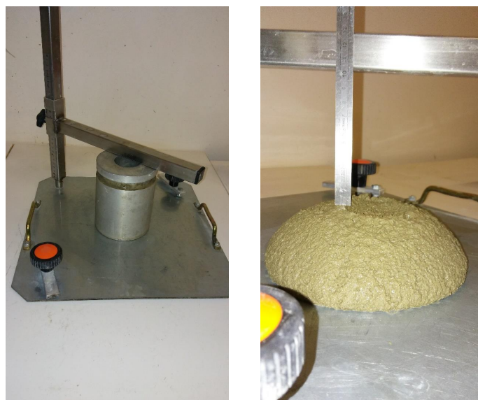
a) Matériels de mesure b) Mesure de l'affaissement
