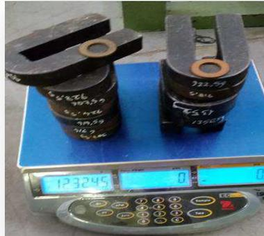
Figure II. 40. Mesure des poids à ajouter sur le système de tension
