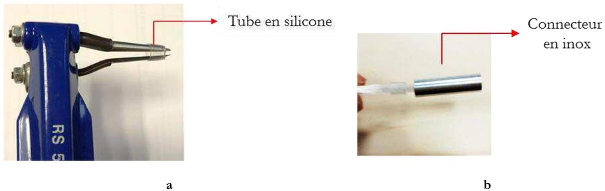
Figure II. 43. Insertion des fibres optiques dans un connecteur inox
