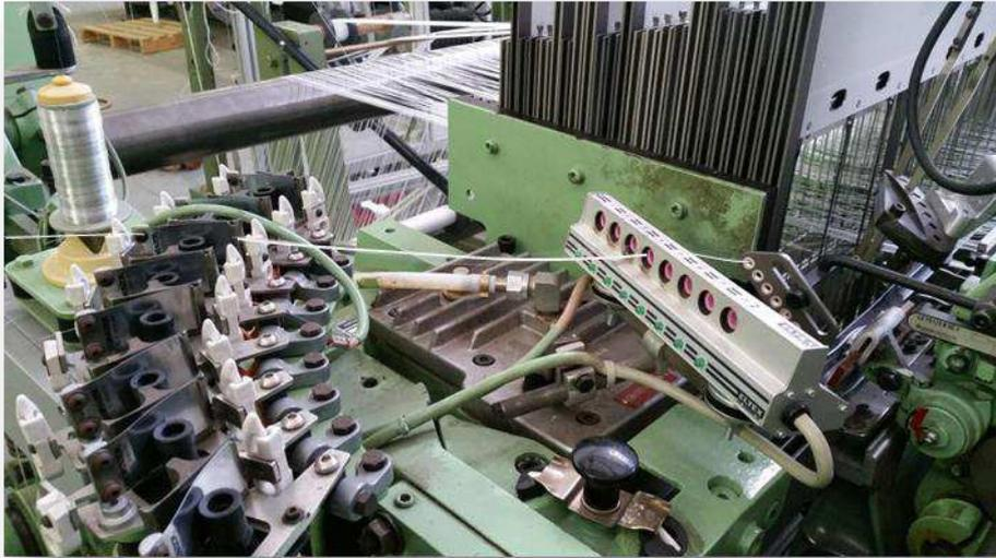
Figure II. 21. Capteurs de casse-trame
