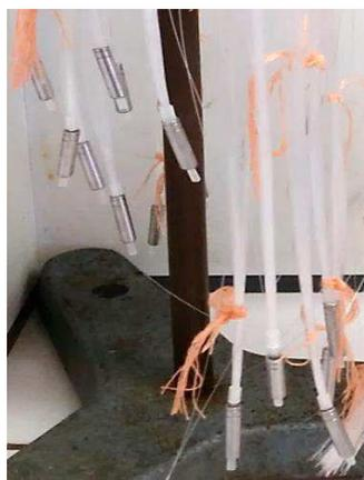
Figure II. 46. Séchage des fibres optiques insérées et résinées dans les connecteurs en inox
