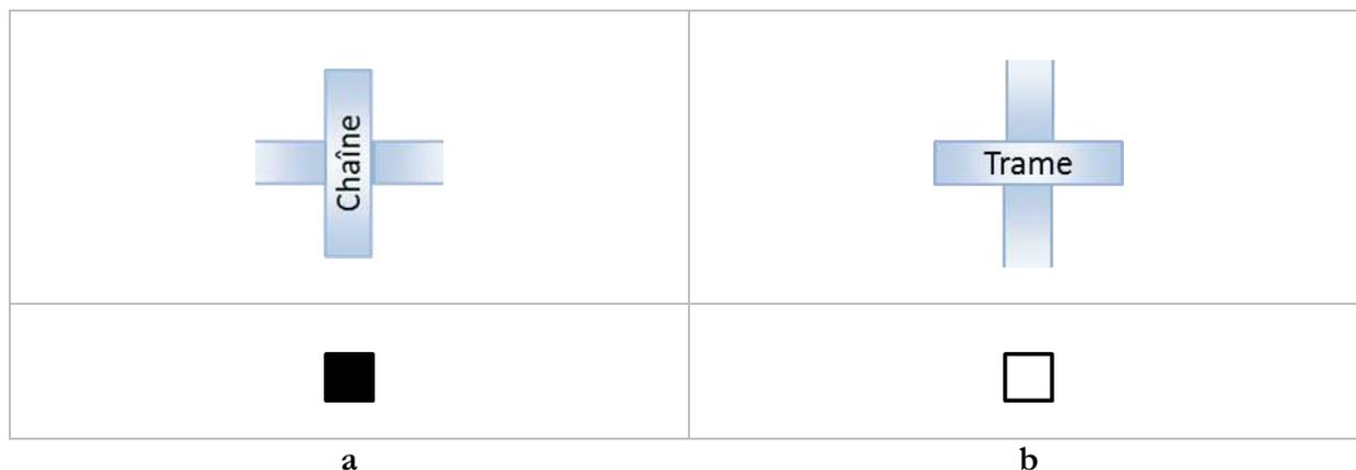
Figure II. 5. Présentation de la trame pris (a) et de la trame laissée (flottée) (b)
