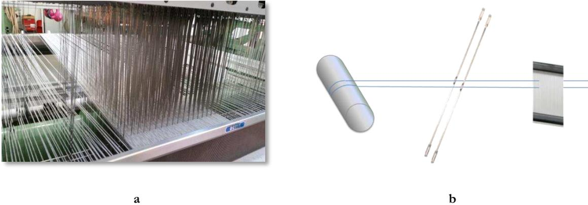
Figure II. 14. Démonstration de l'ordre du rentrage : image (a), schéma (b)
