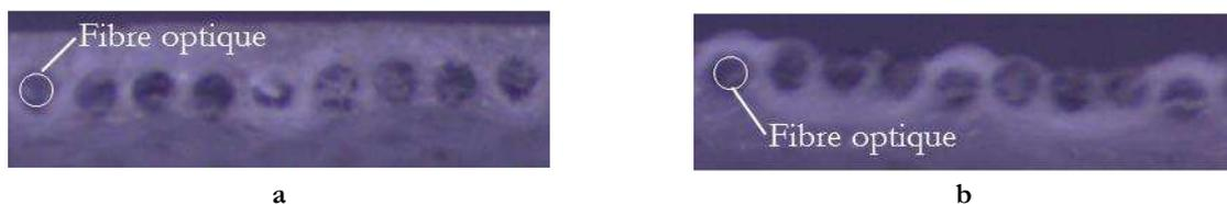
Figure III. 34. Vues en coupe transversale des fibres optiques dans l'armure satin 4 tissé avec une faible tension (a) et forte tension (b)
