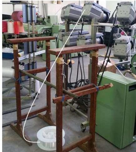
Figure II. 30. Installation de la bobine de fibre optique pour l'insertion de la trame avec le délivreur
