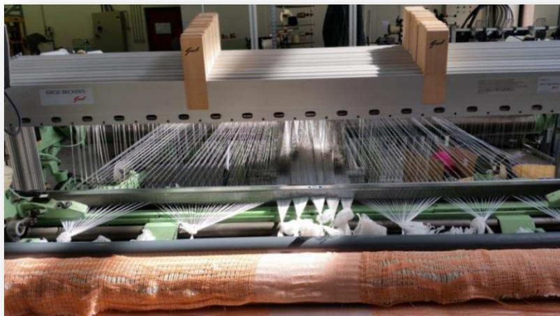
Figure II. 15. Machine à tisser après le rentrage
