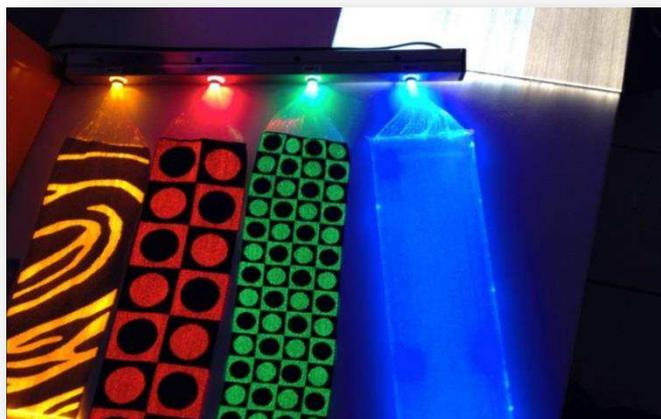
Figure I. 44. Tissus contenant des fibres optiques par Midlightsun [107]
