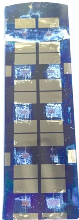
**Figure II.15:** Photographie des 10 micro-dispositifs élaborés sur le même substrat, vue de dessus
