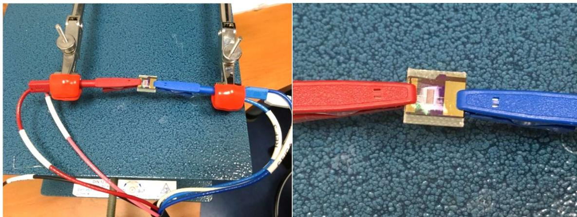
**Figure III.8:** Photographies du banc de caractérisation en configuration à 2 électrodes
