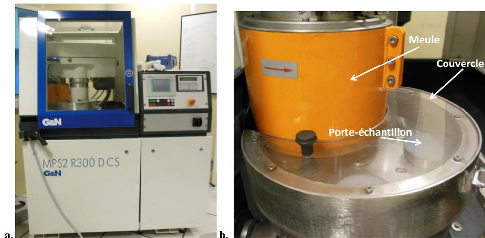
Figure 2.7 - a. Photographie de la machine de meulage, ainsi que b. de ses éléments constitutifs
