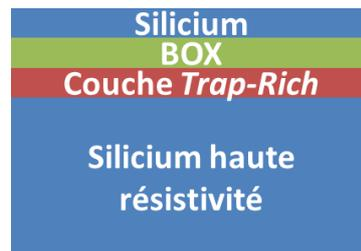
Figure 4.13 – Représentation schématique d'un substrat HR-SOI possédant une couche *Trap-rich*
