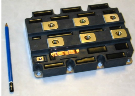
Figure 3. Exemple d'un module de puissance IGBT
