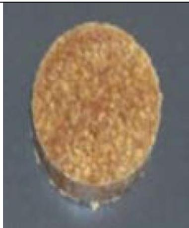
*Figure IV-2 Eprouvette cylindrique du biocomposite HDPE-particules de bois*
