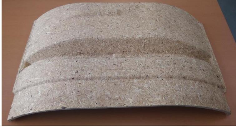
*Figure V-4 Coffrage en copeaux de bois*
