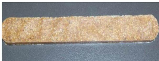
Figure III-1 Eprouvette du biocomposite HDPE-particules de bois
