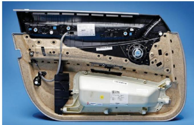
*Figure I-1 Intégration du biocomposite à base de fibres naturelles dans un panneau de portière. Image extraite de Stewart (2010)*
