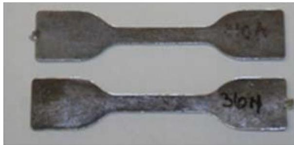
*Figure III-3 Eprouvettes du biocomposite PET-fibres de chanvre*
