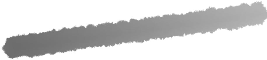
Figure 7.7: Nanofil de silicium à surface rugueuse. Section carrée  $S = 5 \times 5 \text{ nm}^2$ , longueur  $L = 100 \text{ nm}$ . 2 structures différentes ont été créées, avec des amplitudes de rugosité de  $\Delta_r = 0.2$  et  $0.4 \text{ nm}$
