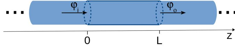
Figure 6.11: **Représentation schématique du NF de longueur  $L$  périodisé suivant  $z$ .  $\varphi_i$  et  $\varphi_o$  sont les courants thermiques entrant et sortant.**
