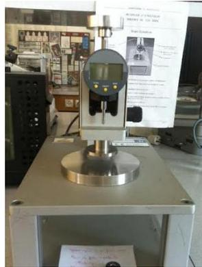
Figure II-2 Testeur d'épaisseur
