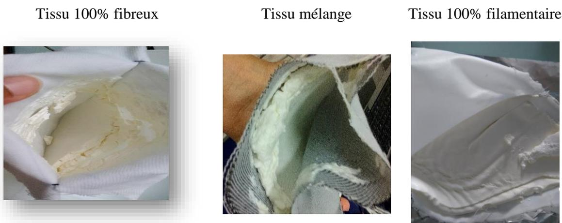
Figure V-21 Débâtissage du gâteau à la fin de la filtration
