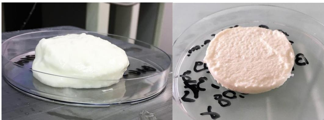
Figure V-18 Les gâteaux de filtration
