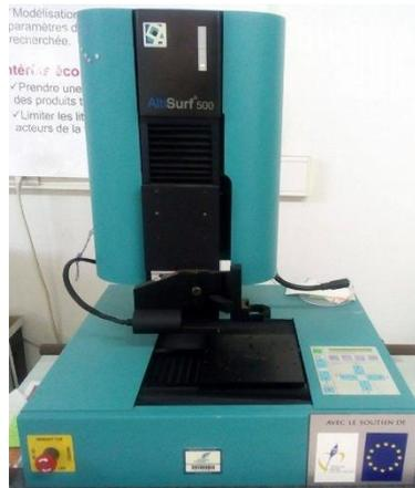
**Figure II-5 Profilomètre AltiSurf500**
