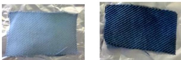
**Figure V-28 Marquage des protéines par le colorant noir amido sur la surface des tissus : avant filtration(1) après filtration (2)**
