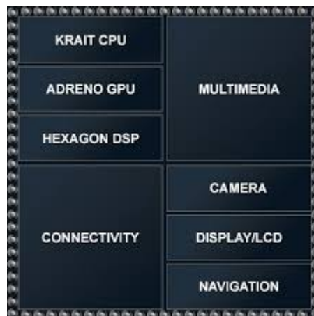
Figure 3.8 – Modules intégrés dans l'architecture Qualcomm SnapDragon 800 (source : https://techspirited.com/snapdragon800-processor-specs )
