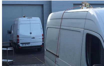
Figure III. 22: Antennes placées au milieu des toits des véhicules
