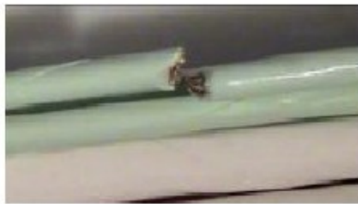
Figure 3-5: Exemple d'un circuit ouvert [7]
