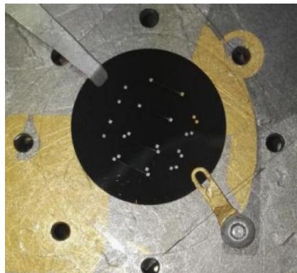
Figure II-27. Image du masque mécanique en nickel fixé sur le film de biopolymère épais.
