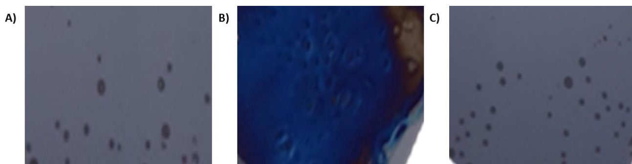
Figure 33 : Photographies microscopiques de films solides obtenus par spin-coating à partir de solutions de A) lignine Kraft, B) de lignine Organosolv et de C) Lignosulfonate à 25 g/l solubilisés dans le DMSO. Grossissement 20x.
