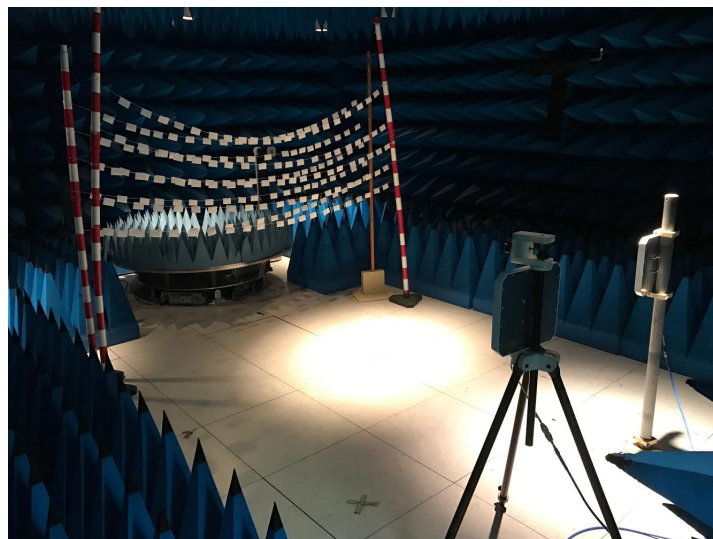
FIGURE 5.3 – Le système de lecture dans la chambre anéchoïque
