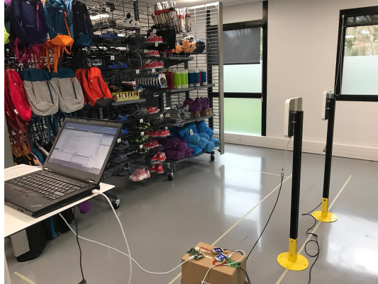
FIGURE 5.9 – Le système de lecture basé sur deux modules ThingMagic M6e
