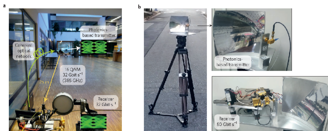
FIGURE 1.10 – a. Transmission multi niveaux à 32 Gb/s sur 25 m avec une modulation 16-QAM délivrée par un réseau de fibres optiques. b. Transmission en temps réel à 50 Gb/s sur 100 m avec une modulation OOK [29].
