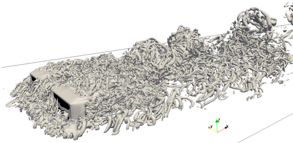
FIGURE 3.47 – Isosurface de \lambda_2 dans le sillage obtenu numériquement pour le cas C_6 [Mercier et al. (2020)].
