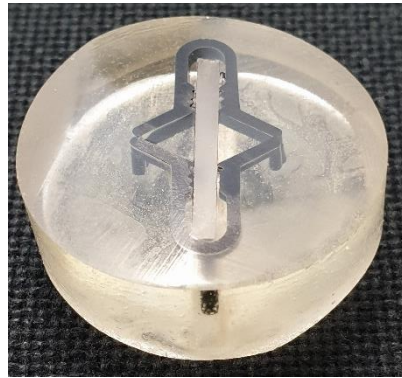
Figure II.3-13 : PEBD enrobé dans la résine à froid
