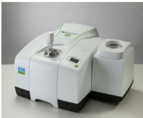
Figure II.3-7 : dispositif d'analyse FTIR Perkin-Elmer Frontier
