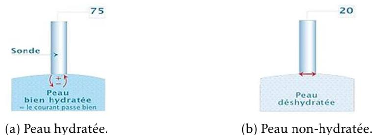
FIGURE 1.58 – Principe de fonctionnement du cornéomètre (ADDIACTIVE 2016).
