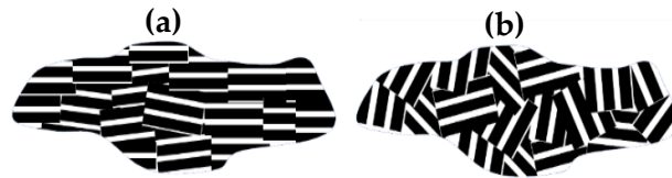
Figure 2.29 Représentation schématique de particules de graphite (a) avec un alignement de graphènes (orientée) ; (b) amorphe
