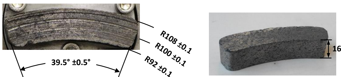
Figure 3.7 Patin d'essai extrait d'un monobloc de G36S (dimensions en mm)
