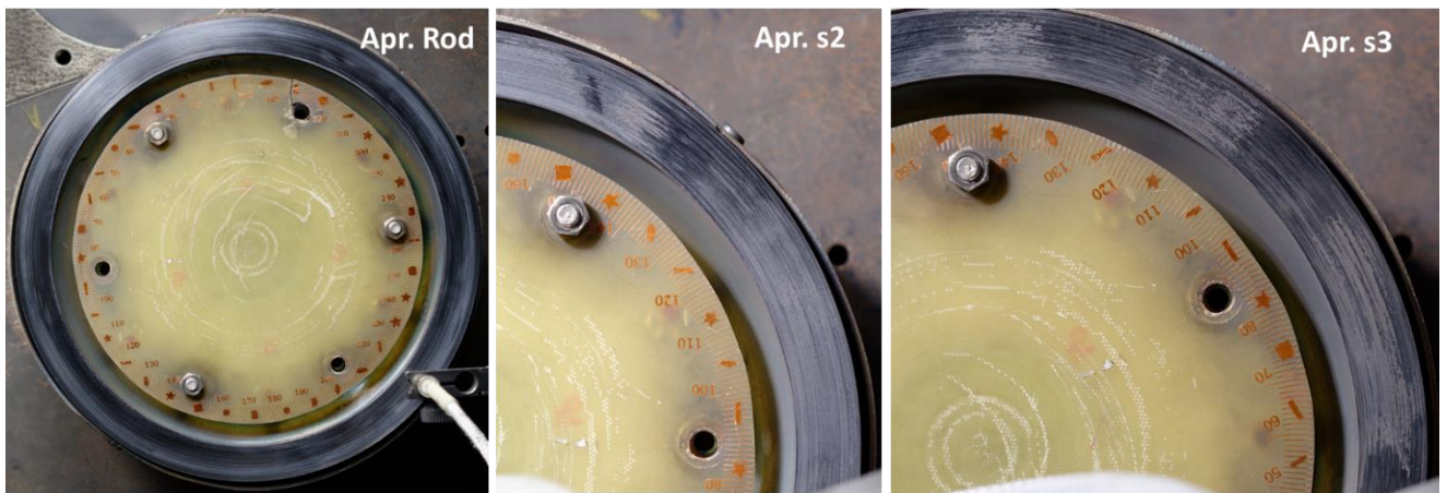
Figure 24 Surface du disque après rodage, s2, s3(TER avec isolation du patin)
