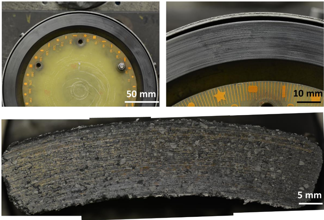
Figure 22 Surfaces disque-garniture après S1 (TER sans isolation du patin)
