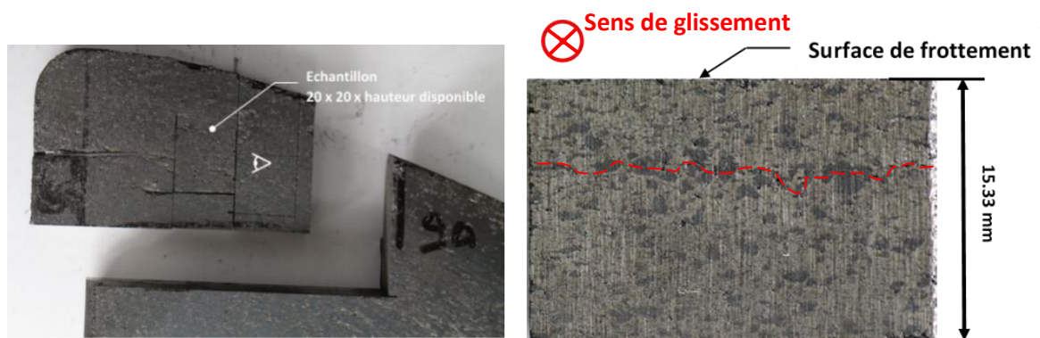
Figure 4.37 Échantillon de compression G36S prélevé au rayon extérieur (Compression (1))
