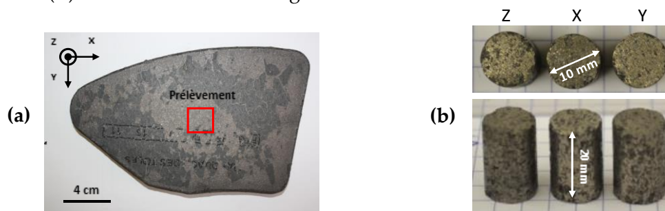
Figure 2.21 (a) Zone de prélèvement des échantillons sur le monobloc G36S ; (b) échantillon de dilatométrie prélevé dans la direction de compression de frittage (Z) et la direction circonférentielle(X) et dans la direction radiale (Y)
